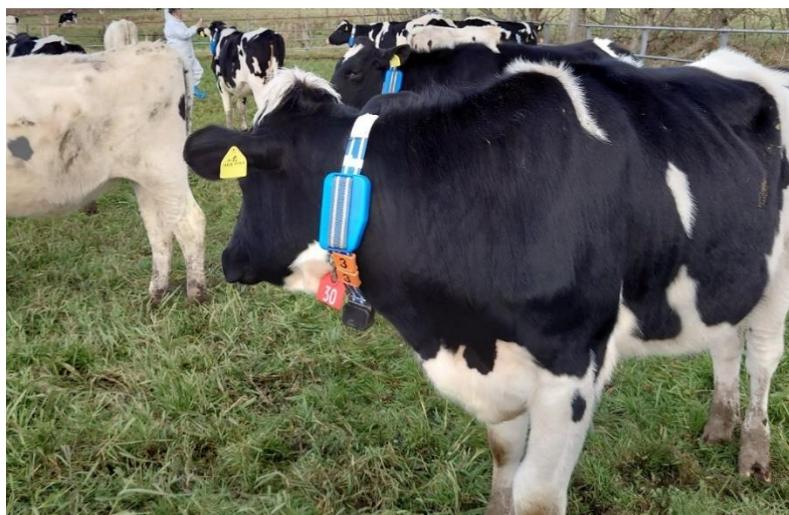
通信方式としてソニーネットワークコミュニケーションズ株式会社が提供する LPWA(※1)の一方式である ELTRES™ IoT ネットワークサービス（以下 ELTRES）(※2)を採用しています。ELTRES の長距離伝送能力は広大な牧場をカバーするために適しています。また、GNSS(※3)標準搭載の上に低消費電力を実現しており、放牧期間に亘って放牧牛の位置を把握することを可能にしています。ソニーネットワークコミュニケーションズが全国展開するパブリック基地局によって受信を行うため、牧場ごとに受信機を設置する必要がありません。
